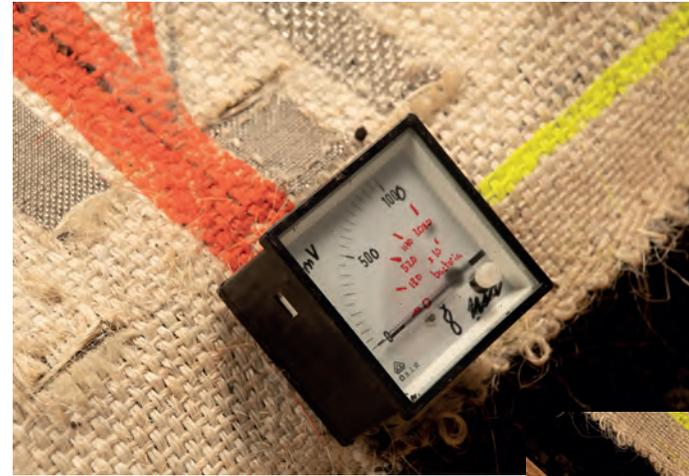
4. El voltímetro analógico traduce el voltaje a un estimado de bacterias en la tierra.
